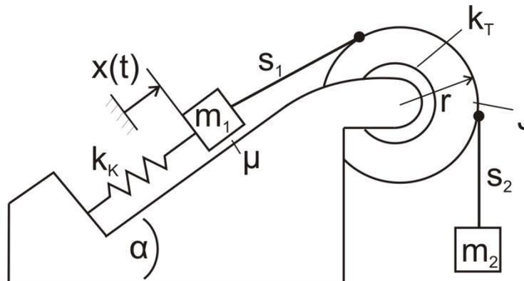
**Abbildung 12:** Drehrad mit gekoppelten Massen
