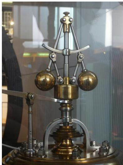
**Abbildung 18: Fliehkraftregler**
